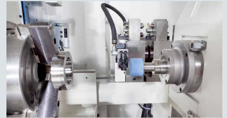
機台工作區域:工件夾持，研磨主軸，砂輪修整
